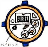
漏水は、地上だけでなく地下や床下などの見えないところの配管で発生していることも考えられます。地下漏水など見た目にはわからない漏水は、メーターで漏水の有無を確認することができます。蛇口など（給水栓）を全部しめて、メーターのパイロットを見てください。パイロットが動いていれば漏水しています。メーターをときどき調べましょう。
