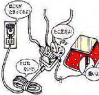
**<配線コード火災>** 傷ついたコードを使用したり、束ねた状態やタンス・机など重い物が載った状態で使用している配線コードは、その部分に負荷がかかって断線し、火災になることがあり大変危険です。傷ついたコードは早めに交換し、束ねた状態での使用やコードの上に重い荷物を載せて使用するのはやめましょう。
