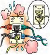
**<たこ足配線火災>** 家電製品やOA機器の普及によって多くの電気器具を使用するようになり、コンセントの数が不足して「たこ足配線」になりがちです。コンセントの電気の許容量を超えて電気器具を使用するとコンセントが過熱し、火災になることがあります。コンセントの電気の許容量を超えるような「たこ足配線」は、やめましょう。
